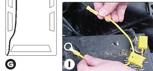
et verrouillez-le en place. Toutes les surfaces des connecteurs doivent être propres et exemptes de saleté.
